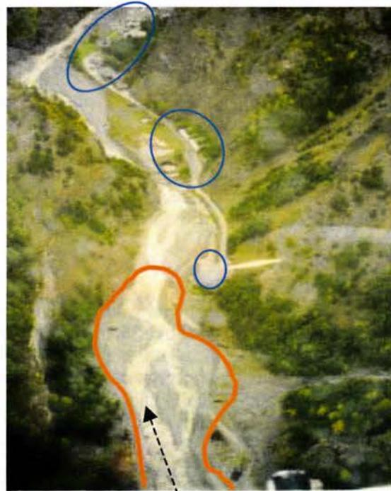
Abb. 1: Oberer Ablagerungsbereich (rot) und Teil der SSE (blau) nach dem Hochwasser 2000
